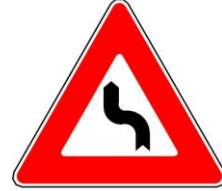
znak »dvostruka krivina ili više uzastopnih krivina od kojih je prva u lijevo«
